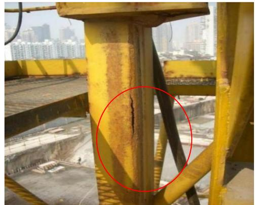
履带吊、塔式起重机等设备、主撑臂结构存在变形、裂纹等情况
